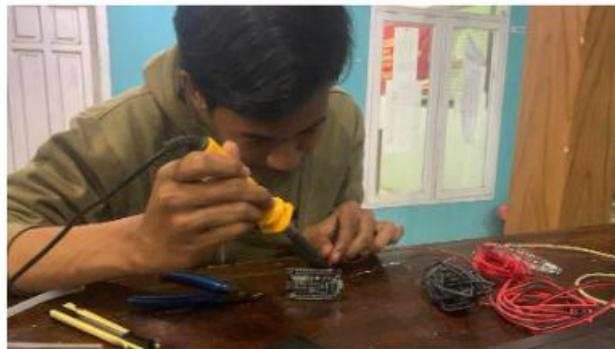
Gambar 3. Proses perakitan teknologi tepat guna yaitu alat presensi otomatis
